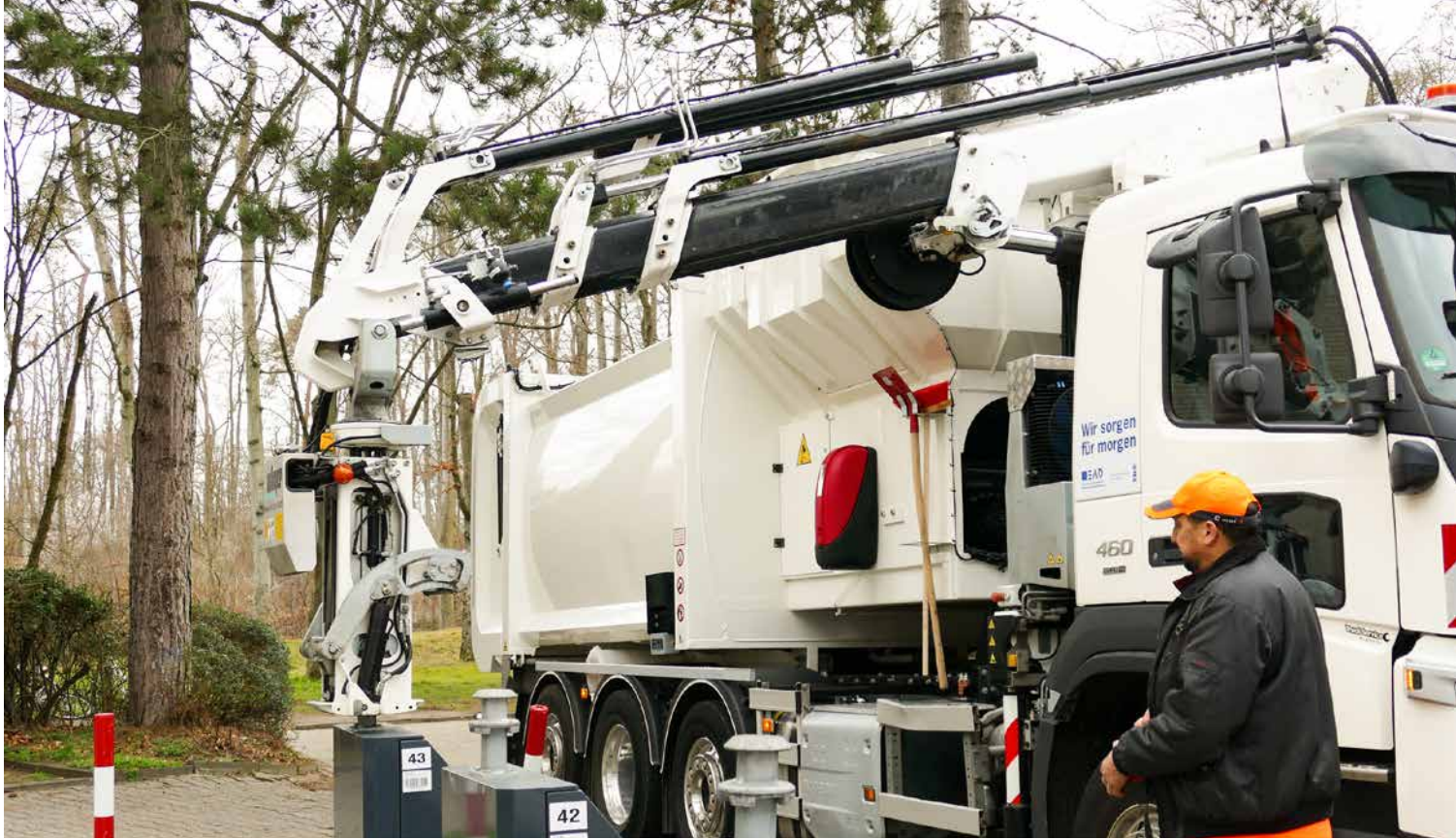
Leerung eines Unterflurbehälters in Darmstadt, © EAD
